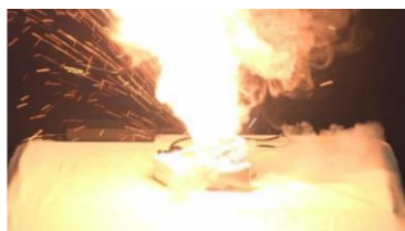
Fig.2 誤った充電方法により 激しく発火するリチウムイオン電池 (2)
