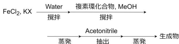
Fig.4 水溶性鉄錯体の合成スキーム
